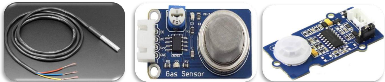
شكل رقم (2) يوضح حساسات استشعار الغاز، والدخان، والحرارة، والحركة، وموصلات.
