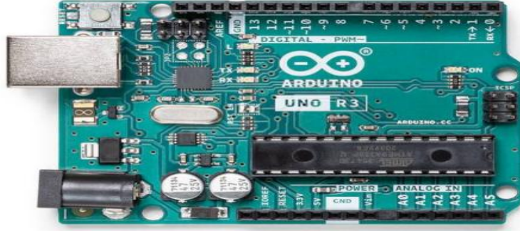
شكل رقم (3) يوضح لوحة Arduino UNO
